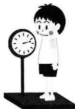
**提示:**测体重时应保持静止状态。因为体重计的示数实际是人对于体重计压力的大小,当保持静止状态时,人对体重计的压力大小等于人的重力。
