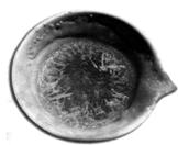
图1 从熔融态结晶出来的硫晶体
