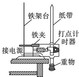
(1) 所需器材有打点计时器(带导线)、纸带、复写纸、带铁夹的铁架台和带夹子的重物, 此外还需 \_\_\_\_\_ (填字母序号) 中的器材。
