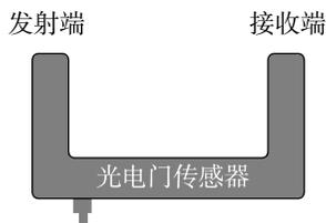
(1) 用光电门测做变速运动的物体的瞬时速度, 在所测量的物体速度较小时, 为了减小误差, 应选择宽度比较\_\_\_\_\_ (选填“宽”或“窄”)的挡光板。
