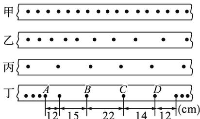
**解析:**速度是单位时间内物体所通过的位移,纸带上每相邻两点间的时间间隔相等,因此物体匀速运动时,相邻两点间的距离相等,所以纸带甲、丙是匀速通过打点计时器的;纸带乙相邻两点间距离越来越大,则速度越来越大,因此纸带乙是越来越快的;纸带丁相邻两点间的距离先变大后变小,说明速度先变大后变小,因此纸带丁是开始越来越快、后来又越来越慢的。若所用电源的频率是 50 Hz,则相邻两点间的时间间隔为 0.02 s,题图中纸带丁,从 A 点通过计时器到 B 点通过计时器有两段时间间隔,所以时间为 0.04 s,位移大小为 0.27 m,这段时间内的平均速度大小  $\bar{v} = \frac{\Delta x}{\Delta t}$ ,代入数值得  $\bar{v} = 6.75 \text{ m/s}$ 。BC 段的位移大小为 22 cm,即 0.22 m,所用时间为 0.02 s,代入上式得平均速度为 11 m/s,而 AD 段的位移大小为 63 cm,即 0.63 m,所用时间为 0.08 s,代入上式得平均速度大小为 7.875 m/s。
