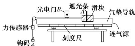
(1) 实验时, 接通气源, 将滑块从  $A$  位置由静止释放, 由数字计时器读出遮光条通过光电门  $B$  的时间  $t$ , 已知  $A$  位置到光电门的距离为  $L$ , 用  $d$ 、 $t$ 、 $L$  表示滑块运动的加速度  $a = \underline{\hspace{2cm}}$ 。
