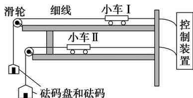
(1)在安装实验装置时,应调整滑轮的高度,使 \_\_\_\_\_;在实验时,为减小系统误差,应使砝码盘和砝码的总质量 \_\_\_\_\_ (选填“远大于”“远小于”或“等于”)小车的质量。
