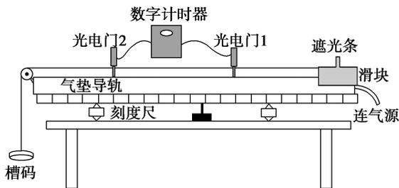
**解析:** 由于滑块经过光电门时遮光条的挡光时间较短, 所以滑块经过光电门的速度可用遮光条挡光时间内的平均速度表示。经过第一个光电门的速度
